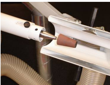
749Z9=M16 Bande sans fin (conique) Ø23x62xø37
