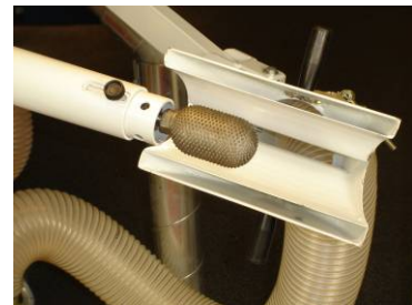
729W17=M16 Râpe (barre) ø50mm longueur 100mm M16
