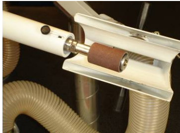
749Z7=M16x45 Bande sans fin Linea ø45 x 70mm
