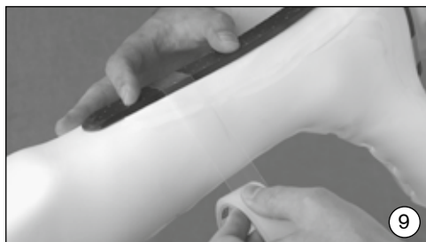
Подготовить модель к глубокой вытяжке. Выше подъема и ниже икроножной мышцы пружину зафиксировать на модели с помощью полиэтиленовой клейкой ленты (627В4). 1 трикотажный перлоновый рукав надеть на модель.
