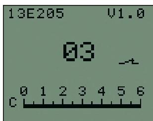
Das Umschalten zwischen Greiffunktion und Rotation erfolgt mittels Sicherheits-Kokontraktion. Siehe Kapitel 5.2 „Methoden der Umschaltung“. Zusätzlich kann die Rückschaltung in die Greiffunktion auch über eine Zeitsteuerung erfolgen. Die Rückschaltzeit wird mit Hilfe des MyoSelect 757T13 eingestellt. Die jeweilige Einstellung kann an der Skala C im Display des MyoSelect abgelesen werden.
