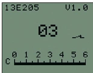
Het omschakelen tussen de grijpfunctie en rotatie vindt plaats met behulp van de veiligheidscocontractie. Zie hoofdstuk 5.2 "Omschakelmethoden". Daarnaast is de terugschakeling naar de grijpfunctie ook via een tijdbesturing mogelijk. De terugschakeltijd wordt met de MyoSelect 757T13 ingesteld. De betreffende instelling kan op de schaalverdeling C op de display van de MyoSelect worden afgelezen.
