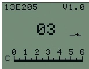
La commutazione tra funzione di presa e rotazione viene effettuata mediante la Cocontrazione di sicurezza. Vedere il capitolo 5.2 "Sistemi di commutazione". Il ritorno alla funzione di presa può essere effettuato anche mediante la regolazione del tempo. Il tempo di ritorno viene impostato con MyoSelect 757T13. L'impostazione corrispondente può essere letta sulla scala C sul display del MyoSelect.
