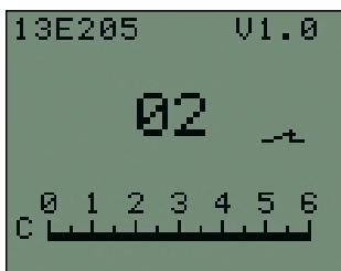
A comutação entre a função agarrar e rotação é efectuada através de co-contracção. Veja capítulo 5.2. "Métodos da comutação". Adicionalmente a comutação de retorno para a função agarrar também pode ser efectuada através de um comando temporizado. O tempo da comutação de retorno é regulado com auxílio do MyoSelect 757T13. A regulação pode ser lida na escala C no display do MyoSelect.
