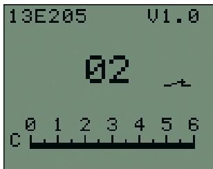
La comutación entre la función de prehensión y la rotación se realiza mediante la cocontracción. Véase al respecto el capítulo 5.2 "Métodos de comutación". Además, también se puede volver a la función de prehensión accionando un control temporal. El tiempo de retroceso se puede ajustar con ayuda del MyoSelect 757T13. El ajuste correspondiente se puede leer en la escala C que aparece en la pantalla del MyoSelect.
