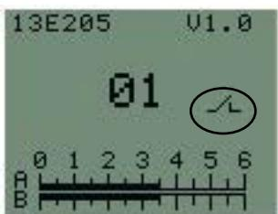
**Schaltersymbol geöffnet:** digitale Ansteuerung des Elektro-Dreheinsatzes.
