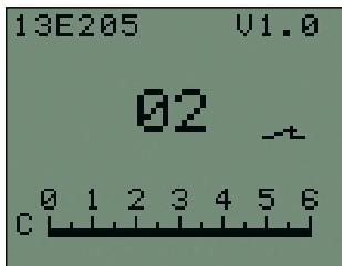
La commutazione tra funzione di presa e rotazione viene effettuata mediante la Cocontrazione. Vedere il capitolo 5.2. "Sistemi di commutazione". Il ritorno alla funzione di presa può essere effettuato anche mediante la regolazione del tempo. Il tempo di ritorno viene impostato con MyoSelect 757T13. L'impostazione corrispondente può essere letta sulla scala C sul display del MyoSelect.
