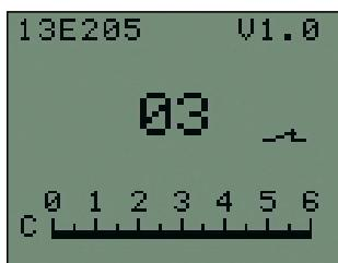
La commutation entre la préhension et la rotation est effectuée par l'intermédiaire de la Cocontraction de sécurité. Voir le chapitre 5.2 « Méthodes de commutation ». En outre, la tempérisation du retour automatique vers la préhension peut aussi être réglé. Ce réglage se fait à l'aide du MyoSelect 757T13. Il peut être lu sur la graduation C de l'écran du MyoSelect.
