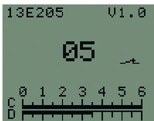
Das Umschalten zwischen Greiffunktion und Rotation erfolgt durch Impulsumschaltung, d.h. das Steuerungssignal muss die Obere Schaltschwelle schnell überschreiten und danach schnell abfallen. Siehe Kapitel 5.2 "Methoden der Umschaltung". Zusätzlich kann die Rückschaltung in die Greiffunktion auch über eine Zeitsteuerung erfolgen. Die Rückschaltzeit wird mit Hilfe des MyoSelect 757T13 eingestellt. Die jeweilige Einstellung kann an der Skala C im Display des MyoSelect abgelesen werden.
